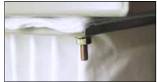
수명이 다된 백필터의 필터가이드볼트 및 너트를 풀어 백필터를 교체해 주십시오.
